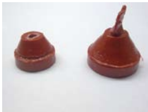
FIGURA 14. PISTÕES DE PLÁSTICO TERMINADOS
