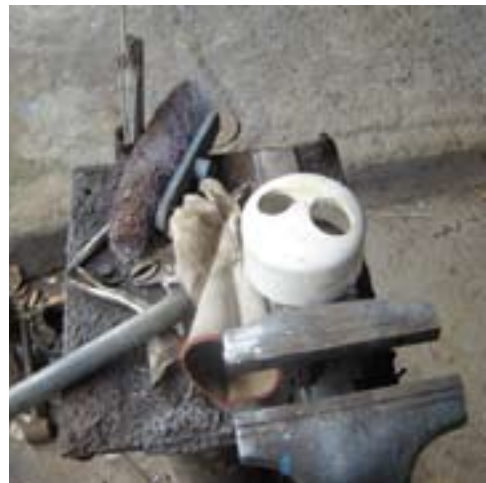
FIGURA 18. TAMPA COM ORIFÍCIOS PARA TUBOS. NICARÁGUA
