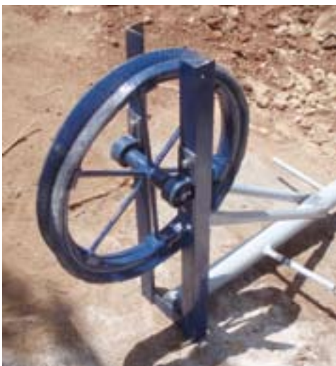
FIGURA 54. ROLAMENTOS NA POLÉ SUPERIOR. MESA, MOÇAMBIQUE
