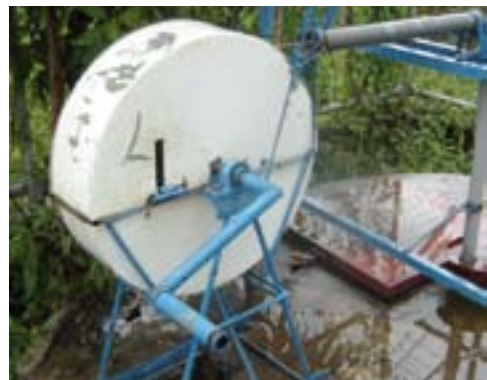
FIGURA 47. BOMBA TRAVADA PELO TRINCO
