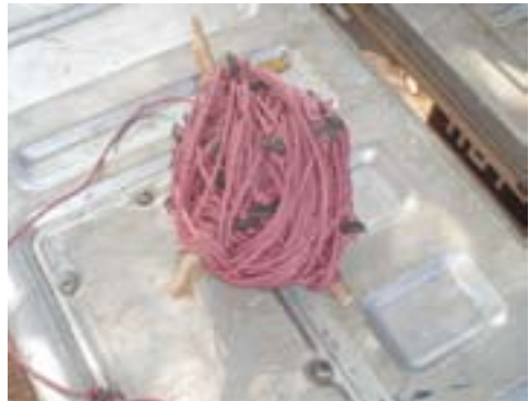
FIGURA 31. CORDA COM PISTÕES PREPARADA PARA A MONTAGEM
