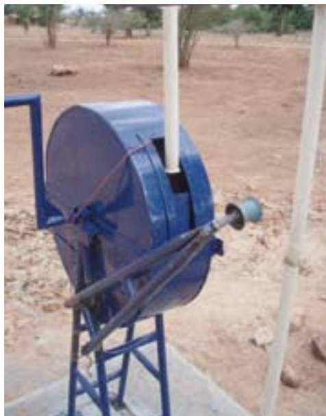
FIGURA 45. CONJUNTO DA POLÉ INSTALADA
